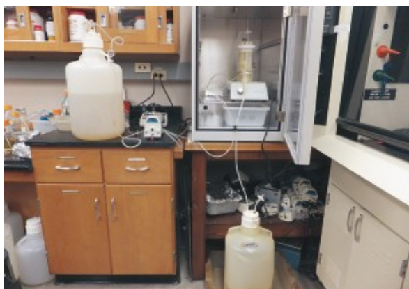
図7 ラボで使われていたバイオフィーム作製装置の1つ。培養器1つ使って培地を1日に8 L 流しています
