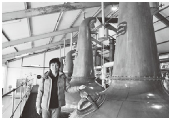
写真6 蒸留所のポットスチル。この形態が蒸留酒ウイスキーの特徴を決める
