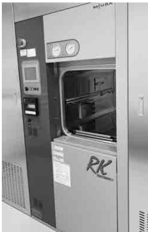
高圧蒸気滅菌装置RK-030EH（汚染領域側）
