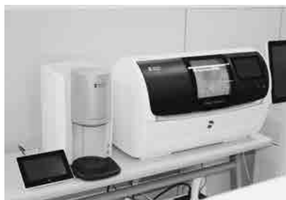
専用ミリングマシン（Primemill：右）とシンタリングファーンズ（SpeedFire：左）
