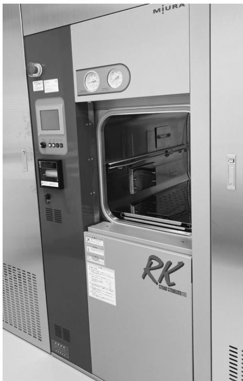
高圧蒸気滅菌装置RK-030EH（汚染領域側）
